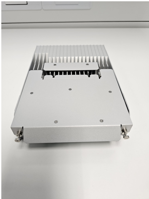
図 13: 交換用ファントレイをモジュールにスライドさせる 10G
