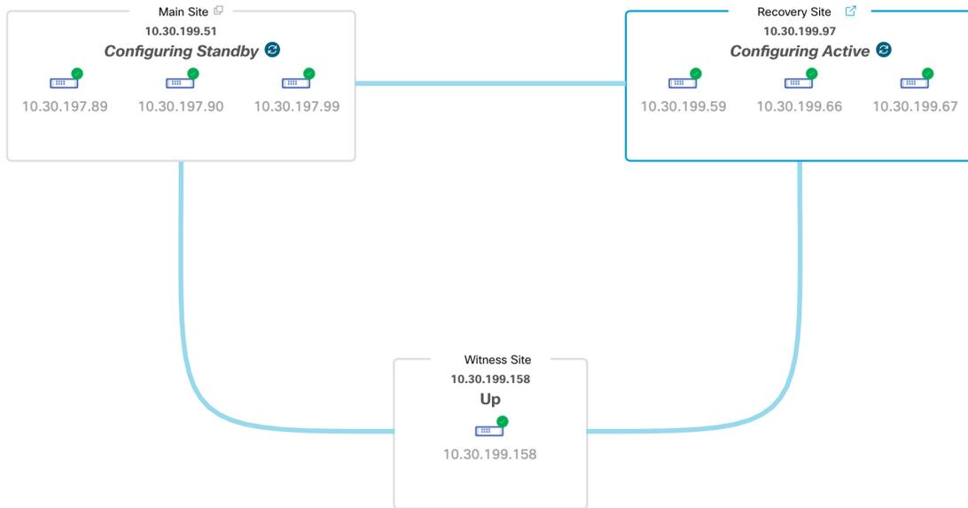
Cisco DNA Center で必要なタスクが完了すると、トポロジに表示されたメインサイト、リカバリサイト、および監視サイトのステータスが更新されます。
