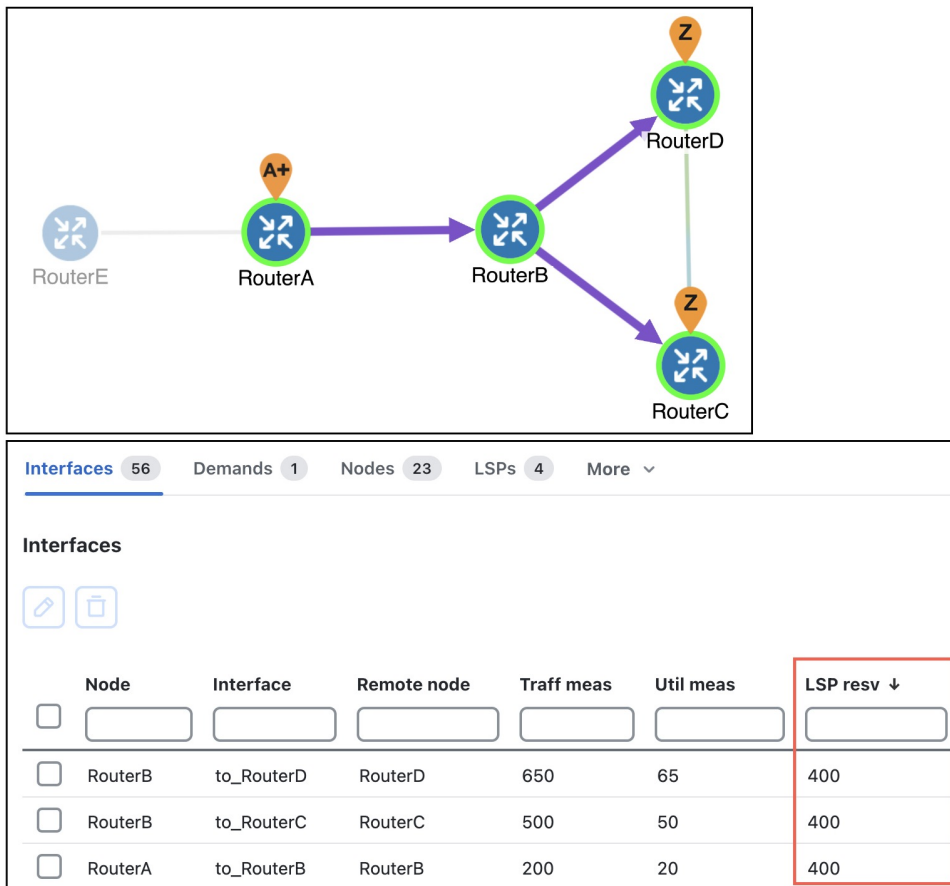
図 90: P2MP LSP がある場合の帯域幅の動作
