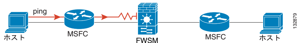
図 24-3 IP アドレスの重複による ping の失敗
