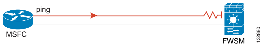
図 24-4 FWSM のルート未設定による ping の失敗
