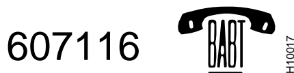
図 2-1 PA-MC-2E1 および PA-MC-8E1 シリアル ポート アダプタの BABT ラベル
