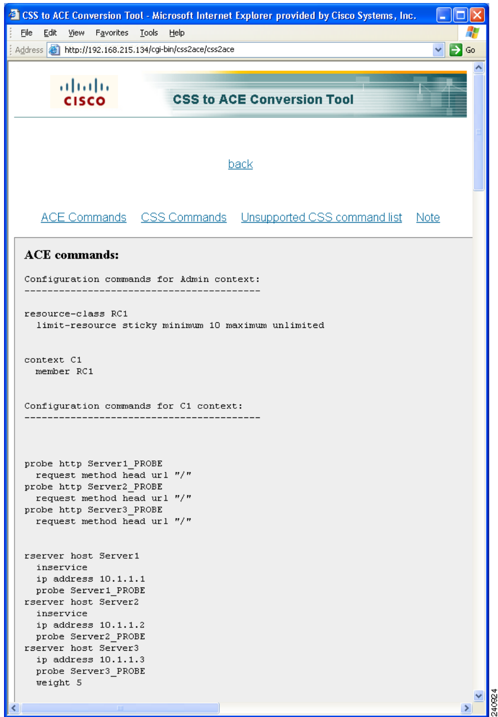
図 5 CSS コマンドから ACE コマンドへの変換例
