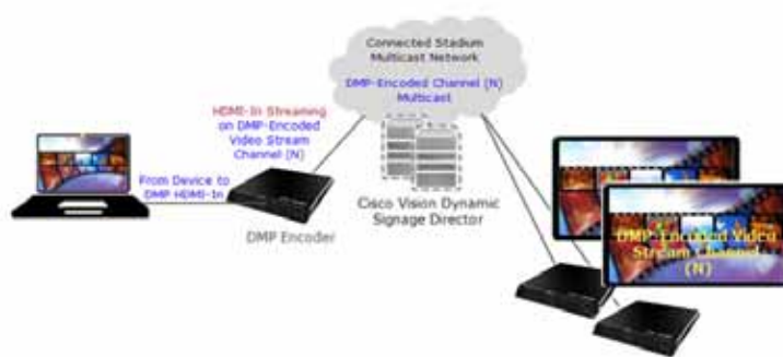
図 10 1 つの DMP から複数の DMP への HDMI-In ストリーミングの例
