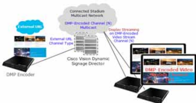
図 7 ディスプレイ ストリーミングを使用して外部 URL を DMP エンコード マルチキャスト チャンネルにストリーミングする例
