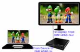
図 6 1 台の TV ディスプレイへのローカル HDMI-In パススルー
