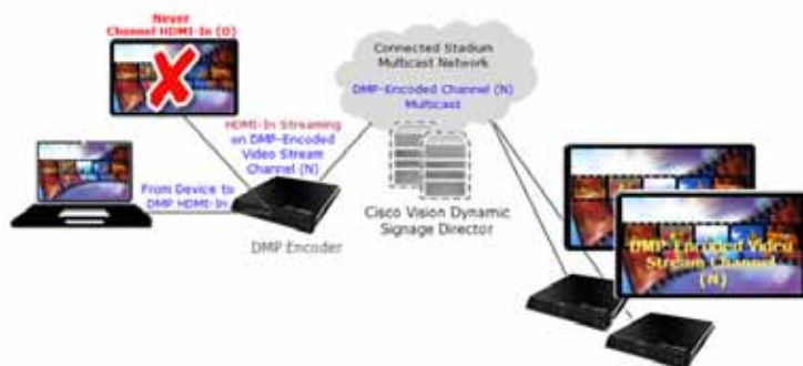
図 11 DMP エンコーダでサポートされていない HDMI-In ストリーミングの設定
