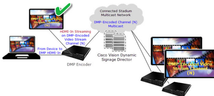
図 12 DMP エンコーダでサポートされている TV ディスプレイを使用した HDMI-In ストリーミングの設定
