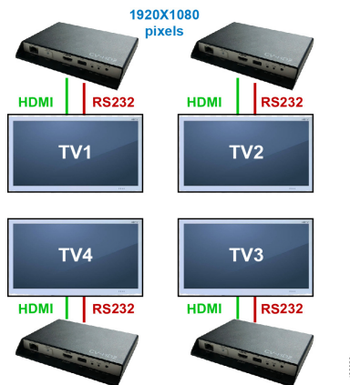
図 1 TV ディスプレイごとに 1 つの DMP を使用したビデオ ウォールの接続
