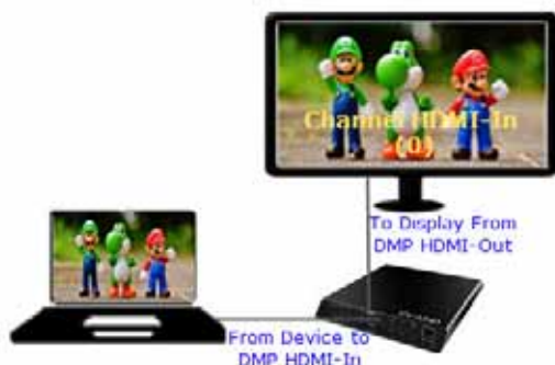
図 6 1 台の TV ディスプレイへのローカル HDMI-In パススルー
