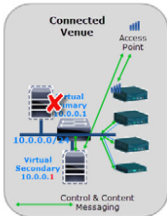
図 4 Cisco Vision Dynamic Signage Director 手動フェールオーバーにおける冗長性
