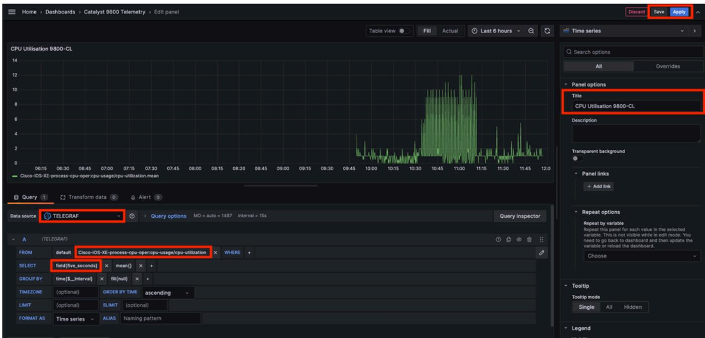
前の図の「Save/Apply」ボタンを押すと、Catalyst 9800コントローラのCPU使用率を時系列で示す図がダッシュボードに追加され
