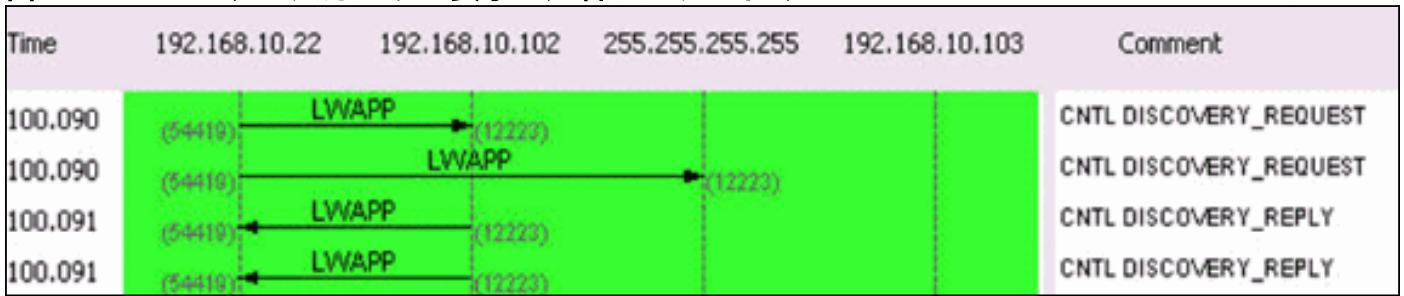
図 2 : LWAPP ディスカバリの要求と応答の packets フロー
