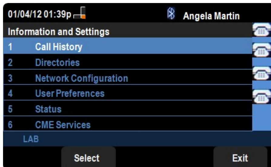
ステップ2:[Network Configurations]に移動し、[Select]を押します。
