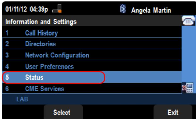
ステップ2: ナビゲーションキーを使用し、[Status]まで下にスクロールします。[選択]ソフトキーを押します。
