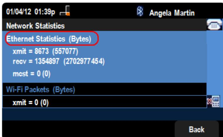
ステップ4:[Network Statistics]ページで、イーサネットパケットの転送速度を確認できます。パケットのサイズはバイト単位で表示されます。
