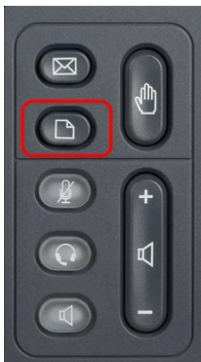
ステップ2:IP Phoneのセットアップボタンを押して、[情報と設定]メニューを表示します。
