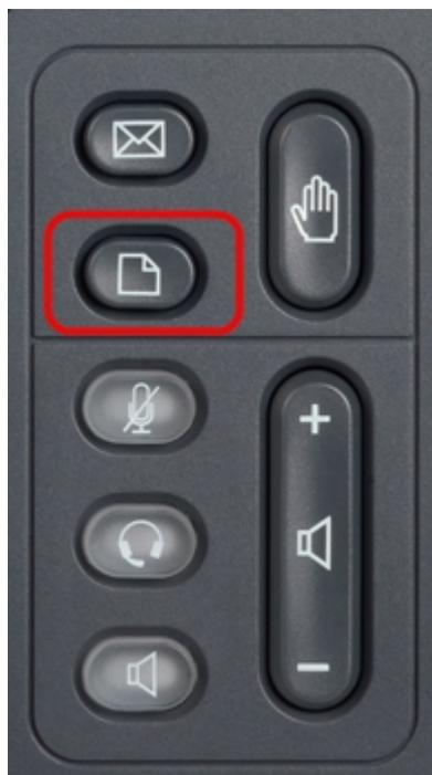
ステップ1:IP Phoneのセットアップボタンを押して、セットアップメニューを表示します。
