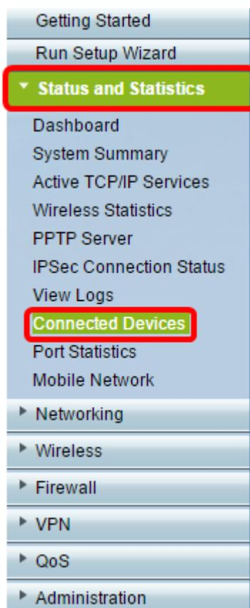
注：RV110W、RV130、またはRV130Wを使用している場合は、[Status] > [Connected Devices] に移動します。
