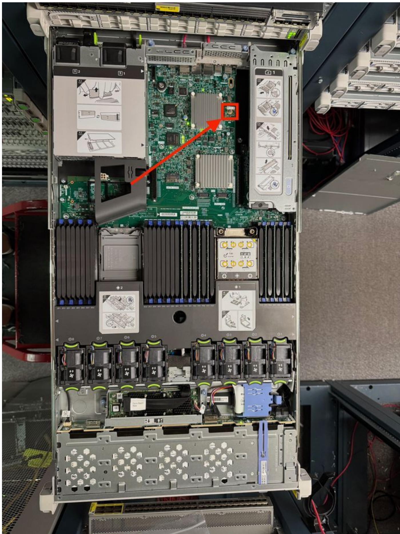
画像 1.SNS 3700シリーズアプライアンス内のTPMモジュールの場所
