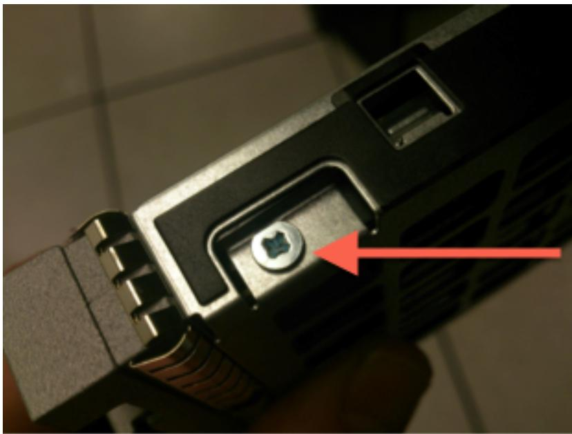
図：4本のプラスネジでドライブをスレッドに固定します。両側に2つ
