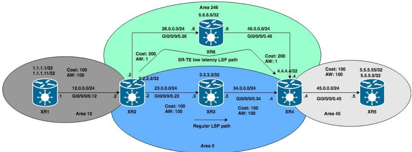
次のケースでは、このOSPFエリア間トポロジを使用します。例は、エリア境界を越えるXR1からXR5へのSR-TEトンネルを計算する試みに基づいています。
