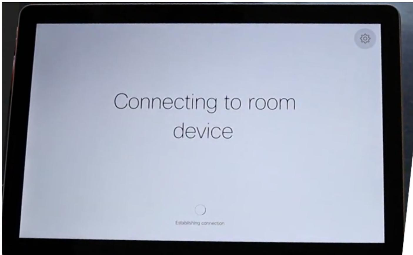
Webex Room Navigatorが最初に起動すると、ルームデバイスに接続してソフトウェアイメージをダウンロードします。
