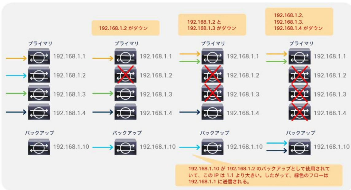
図 76. 障害ノードの数がバックアップ PBR ノードの数よりも多い複数障害のシナリオ
