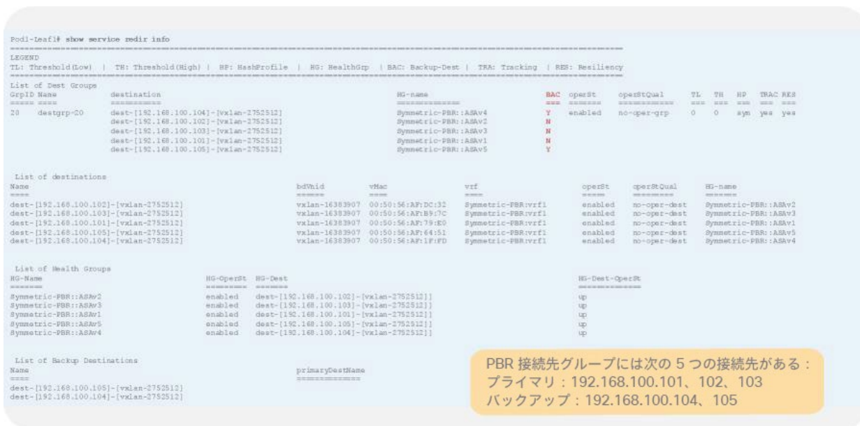
図 136. コンシューマリーフノードとプロバイダリーフノードでのトラッキングとバックアップステータス（すべての PBR 接続先が稼働中）
