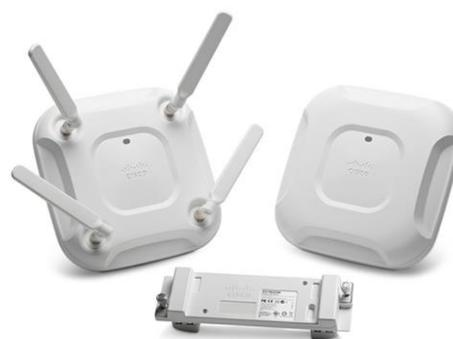
Cisco® Aironet® 3700 シリーズは、新しい IEEE 802.11ac 仕様に対応している、業界唯一の 4 X 4 MIMO、3 空間ストリームのエンタープライズ クラス アクセス ポイントです。企業とサービス プロバイダーのいずれのお客様にもトップレベルのパフォーマンスと高密度エクスペリエンス (HD エクスペリエンス) を提供します。Aironet 3700 シリーズを使用することで、スマートフォン、タブレット、高性能ラップトップなど、802.11ac に対応した新世代の Wi-Fi クライアントにもサポート対象を拡大できます。
