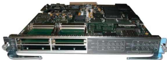
図 1 Cisco Catalyst 6900 シリーズ 4 ポート 40 ギガビット イーサネット ファイバ モジュール
