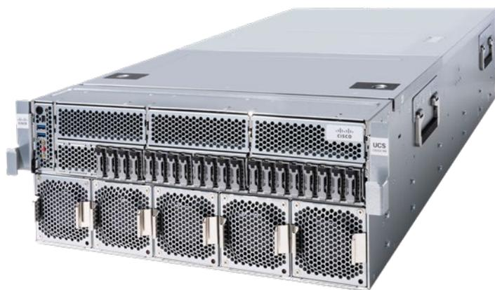
UCS C845A M8 サーバーは、2 ~ 8 個の NVIDIA GPU で構成できます。構成に応じて、PCIe ベースの NVIDIA H100 NVL、H200 NVL、または L40S GPU から選択できます。MGX 設計の洗練により、他の次世代 NVIDIA GPU も、これらの GPU が利用可能になると、この同じプラットフォームに導入される予定です。
