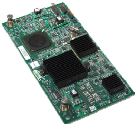
図 1 Cisco UCS M71KR-Q QLogic Converged Network Adapter(CNA; 統合型ネットワークアダプタ)
