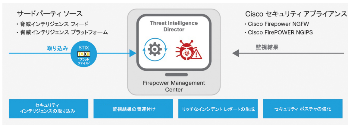
図 3. Threat Intelligence Director とサードパーティ セキュリティ インテリジェンスの統合
