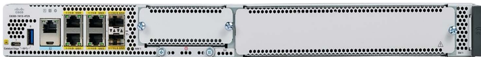
図 3. C8300-1N1S-4T2X は、1つの SM スロットと 1つの NIM スロットに加え、2つの 10Gbps および 4つの 1Gbps 組み込みレイヤ 3 イーサネットポートを備えた 1RU プラットフォームです。
