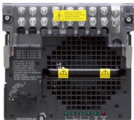
Figure 1. Cisco 7600 シリーズ 6,000 W DC 電源装置
