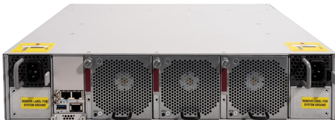
図 3. Cisco C9550 シリーズ スマートスイッチの背面図
