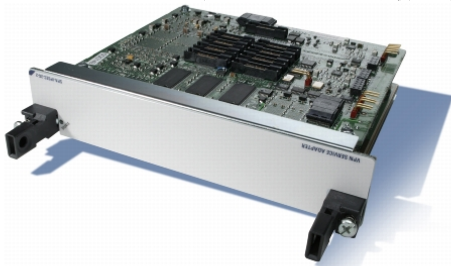
図 1 Cisco XR 12000 IPSec VPN SPA Cisco IPSec VPN SPA は、スケーラブルでコスト効率の高い VPN パフォーマンスを Cisco XR
