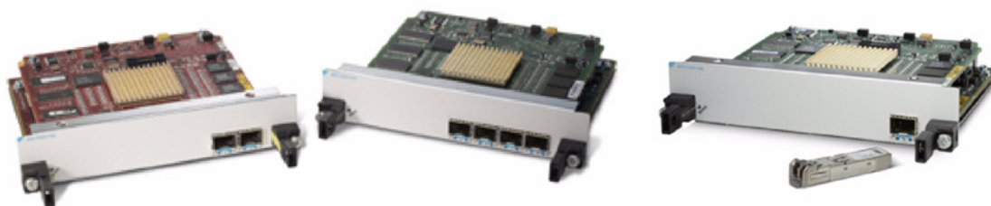
図 1 Cisco 2ポートおよび4ポート OC-3 ATM SPA と Cisco 1ポート OC-12 ATM SPA
