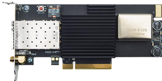
図 1 Cisco Nexus 高分解能タイムスタンプ キャプチャ NIC
