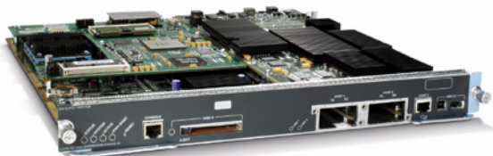
図 2 10 ギガビット イーサネットを 2 ポートと PFC3B を備えた Supervisor Engine 32 (製品番号 WS-SUP32-10GE-3B)
