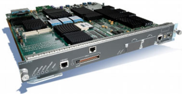
図 2 10 ギガビット イーサネットを 2 ポートと PFC3B を備えた Supervisor Engine 32 PISA
