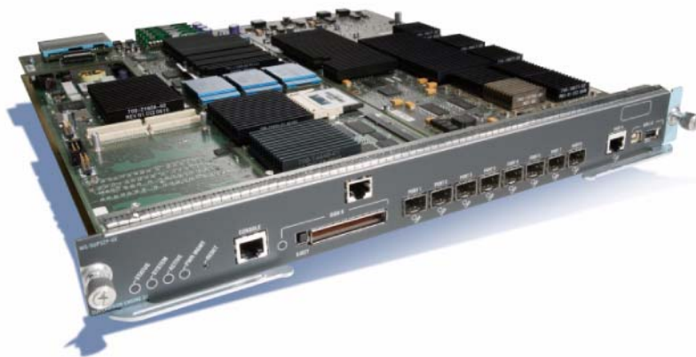
図 1 ギガビット イーサネットを 8 ポートと PFC3B を備えた Supervisor Engine 32 PISA
