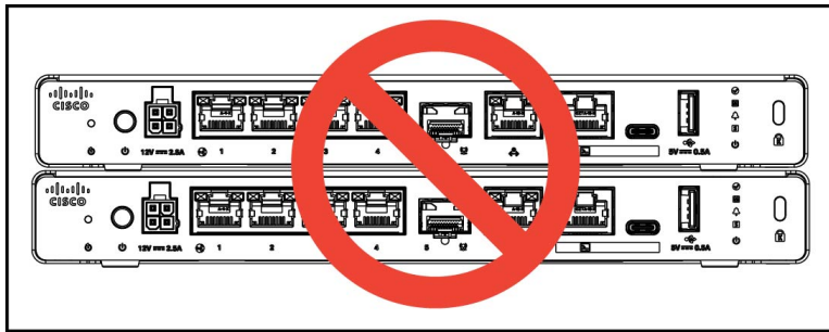
Figura 5: Etichetta "Non impilare" sullo chassis
