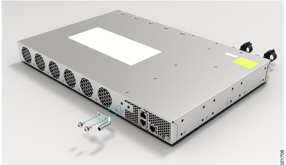
Figura 12: Capocorda di messa a terra
