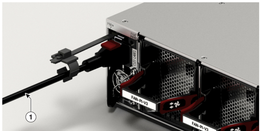
Figura 66: Collegamento dell'alimentazione CA: Cisco 8712-MOD-M
