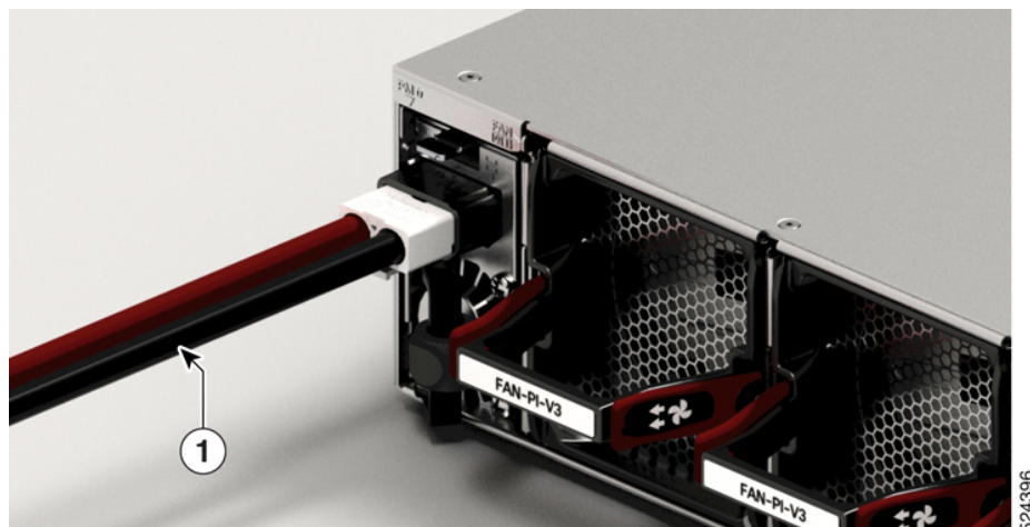
Figura 69: Collegamento dell'alimentazione CC: Cisco 8712-MOD-M
