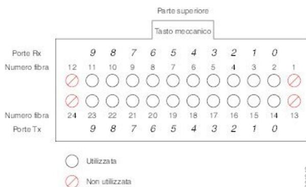
Guardando l'alloggiamento del modulo CPAK con il tastino meccanico in alto, le fibre sono numerate in sequenza come indicato di seguito:
