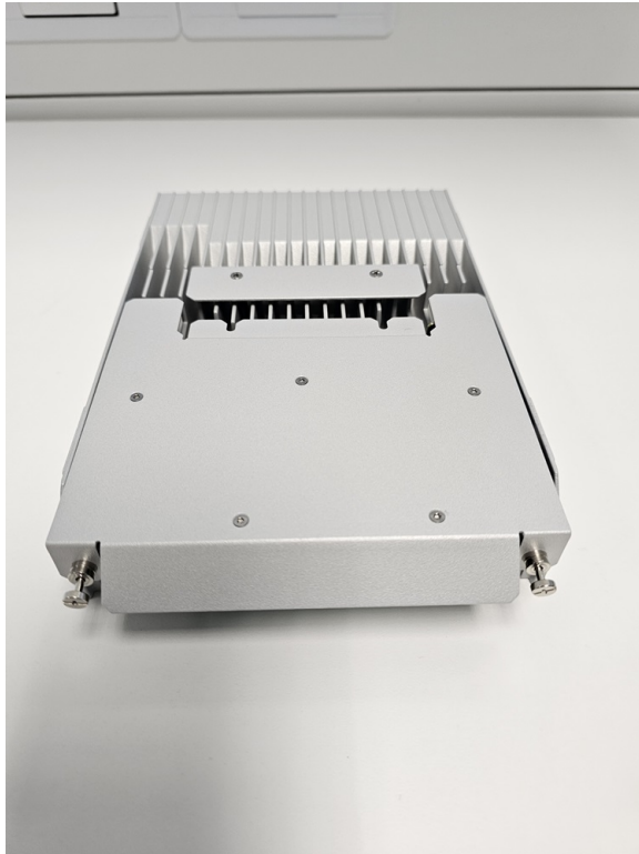
Figura 13: Inserimento del vano ventole di ricambio nel modulo 10G
