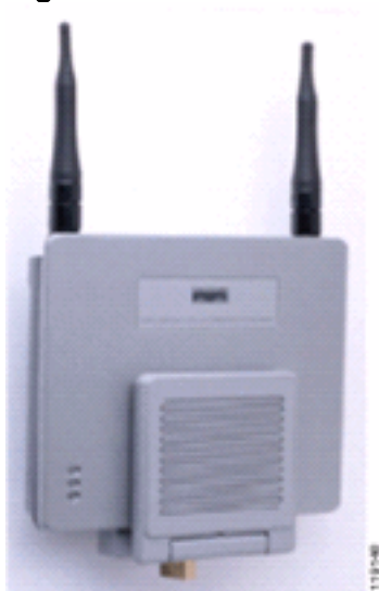
Figura 23 - Cisco AP1200 installato su una parete
