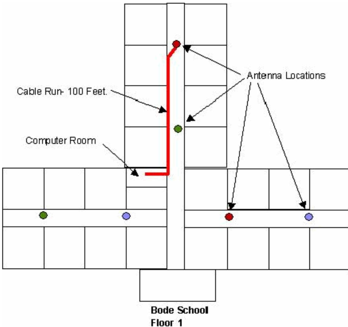
Un cavo coassiale trasporta energia a radiofrequenza (RF) tra le antenne e le apparecchiature radio. Un cavo antenna introduce la perdita di segnale nel sistema antenna sia per il trasmettitore che per il ricevitore. Per ridurre la perdita di segnale, ridurre al minimo la lunghezza del cavo e utilizzare solo cavi dell'antenna a perdita ridotta (LL) o a perdita ultrabassa (ULL) per collegare i dispositivi radio alle antenne.
