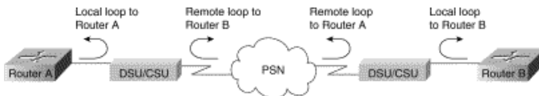
Figura 15-9: Test di loopback locale e remoto CSU/DSU
