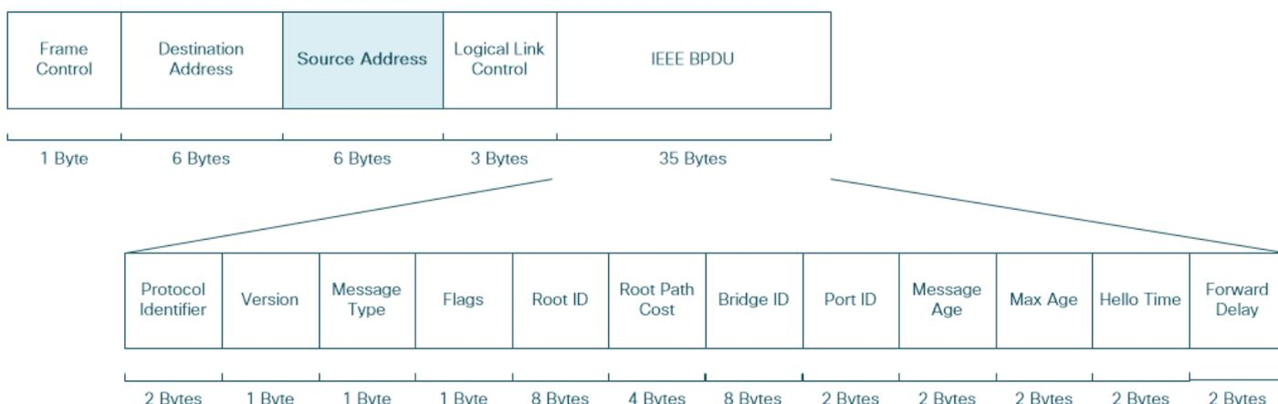
Gli switch Cisco serie Nexus usano l'indirizzo MAC virtuale nel campo dell'indirizzo MAC di origine dei BPDU inviati alle interfacce del canale delle porte virtuali. Questo indirizzo MAC è lo stesso per entrambi i peer vPC. Ciò garantisce un comportamento coerente e uniforme in scenari di failover vPC.
