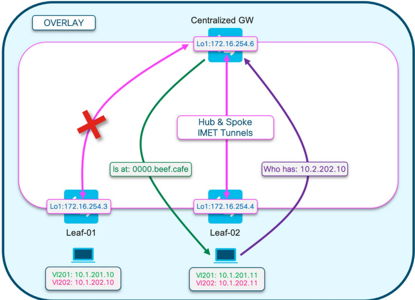
Questo diagramma consente di visualizzare il flusso del processo di risoluzione ARP descritto in questa sezione.
