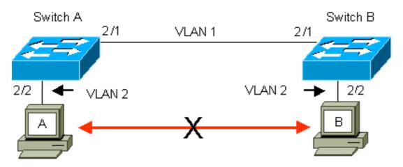
La soluzione è abilitare il trunking ISL sul collegamento tra gli switch A e B. Il trunking aggiunge un'intestazione VLAN a ciascun frame durante la trasmissione (multiplex) su un collegamento trunk. Questa aggiunta consente allo switch all'altra estremità del collegamento di demultiplare i frame; infine, lo switch inoltra i frame alle porte VLAN appropriate.
