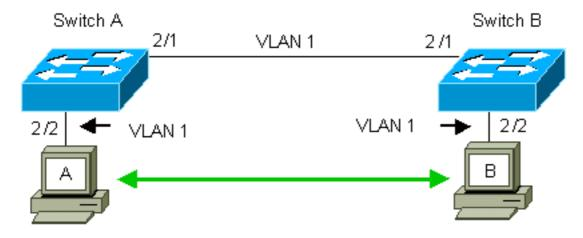
Per impostazione predefinita, gli switch A e B hanno le porte 2/1 nella VLAN 1. Questa configurazione consente il flusso del traffico proveniente da altre porte nella VLAN 1 tra gli switch senza configurare il trunking. I riferimenti alla "VLAN di gestione" si applicano alla VLAN 1.
