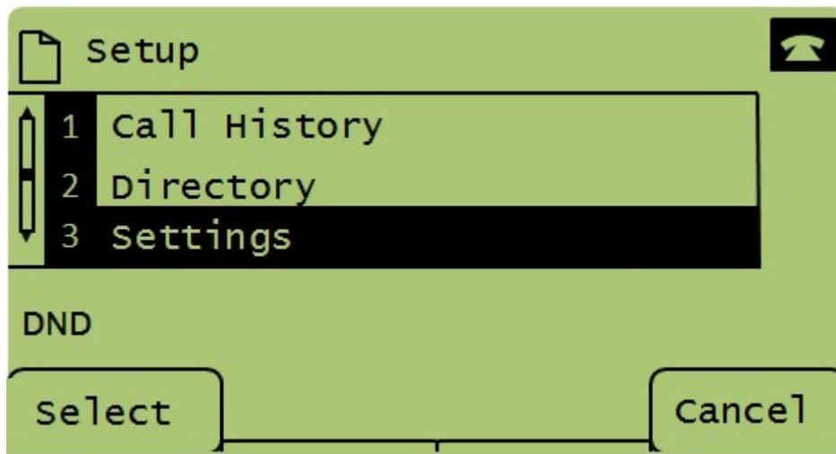
Passaggio 3. Premere 5 o scorrere verso il basso con i tasti di navigazione fino all'opzione 5 e premere **Select** soft-key per aprire il menu Network Configuration (Configurazione di rete).
