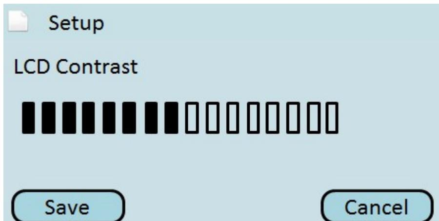
Passaggio 2. Utilizzare i tasti di navigazione destra e sinistra per regolare il contrasto dello schermo LCD a un livello ottimale.
