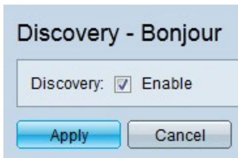
Passaggio 2. Selezionare **Enable** nel campo Discovery per abilitare globalmente il rilevamento di Bonjour sullo switch.
