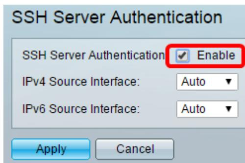
Passaggio 3. (Facoltativo) Nell'elenco a discesa Interfaccia di origine IPv4, scegliere l'interfaccia di origine il cui indirizzo IPv4 verrà utilizzato come indirizzo IPv4 di origine per i messaggi utilizzati nella comunicazione con i server SSH IPv4.
